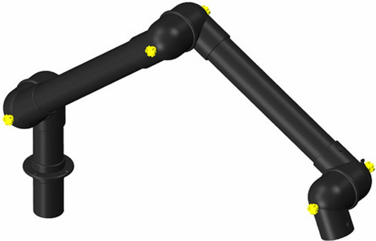
Das System DN75 von Alsident ist für viele verschiedene Bereiche einsetzbar, unter anderem für Labore, bei der Lasertechnik, in der chemischen und pharmazeutischen Industrie sowie auch für Fachräume in Schulen. Die Rohre haben einen Durchmesser von 75 mm und die empfohlene Luftmenge beträgt 80 m<sup>3</sup>/h bis 180 m<sup>3</sup>/h. Die ESD Absaugarme entsprechen natürlich der DIN EN 61340-5-1 und sind bestens für die ESD Schutzzone geeignet.
