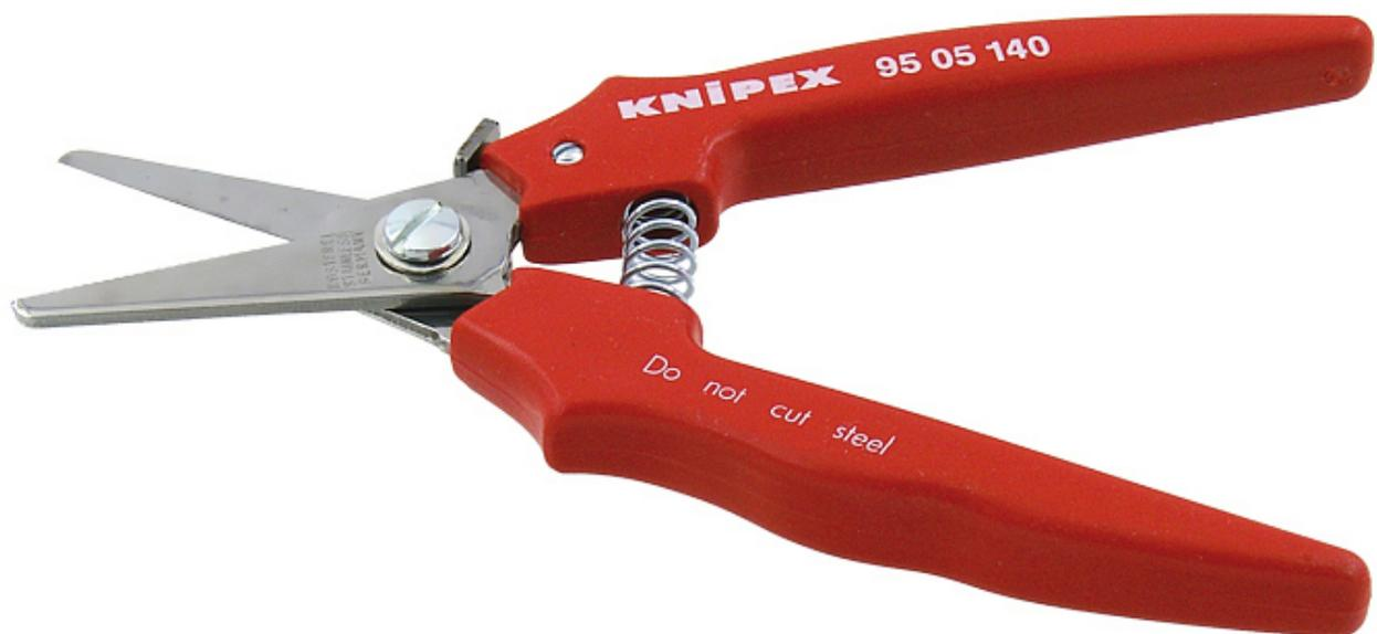
Zum Schneiden von Pappe, Kunststoff, Al-, Ms- und Cu-Folien. Nicht für Stahldraht und Eisenblech geeignet. Gehärtete Schneiden mit Präzisionsschliff. Mit Öffnungsfeder und Sperrklinke. Klemmschutz verhindert Quetschverletzungen. Nachstellbares Schraubgelenk.
