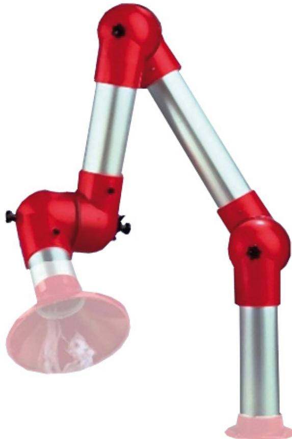
Das System DN75 von Alsident ist für viele verschiedene Bereiche einsetzbar, unter anderem für Labore, bei der Lasertechnik, in der chemischen und pharmazeutischen Industrie sowie auch für Fachräume in Schulen. Die Rohre haben einen Durchmesser von 75 mm und die empfohlene Luftmenge beträgt 80 m<sup>3</sup>/h bis 180 m<sup>3</sup>/h.
