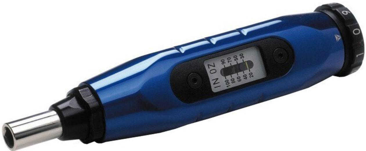
Benutzerfreundliches Design, angenehm in der Handhabung. Mit drehmomentbegrenzender Nocken-Kupplung für Wiederholgenauigkeit und Präzision. Gut ablesbare Fensterskala. Schnelle und genaue Einstellung des Drehmomentes mit dem leicht herausziehbaren Einstellring.
