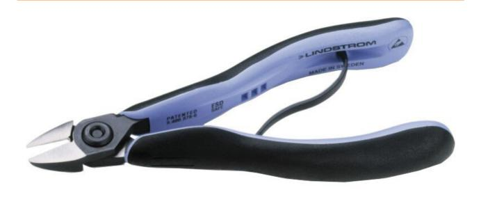
Aus Hochleistungs-Kugellagerstahl gefertigt, brüniert. Schneiden und Backen computergeschliffen, dadurch höchste Präzision und konstante Qualität. Induktionshärtung der Schneiden auf 63-65 HRC. Griffe aus 2 Komponenten, mit Öffnungsfeder. Schneidkapazität: Kupferdraht
