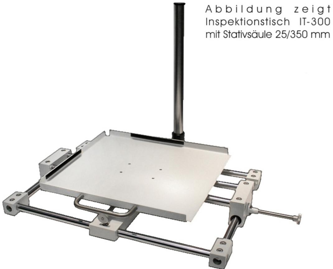
Der Verschiebetisch von 4HJena eignet sich zur feinfühligem Ausrichtung von Prüflingen bei der optischen Inspektion.
