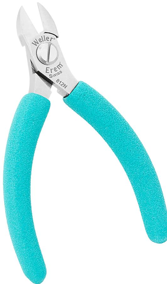
Der perfekte Schnitt - kraftvoll, scharf und langlebig. Immer. Die Weller Erem Serie 800 Maxi ist ein Sortiment großer Präzisionsschneider für allgemeine Schneidanwendungen in der Elektronik zum Schneiden großer Drahtdurchmesser. Die Schneider werden aus hochwertigem Werkzeugstahl mit auf 63-65 HRc gehärteten Schneidkanten hergestellt. Die Präzisionsschneider haben eine nicht reflektierende Oberfläche, sind ESD-sicher und können nachgeschärft werden.
