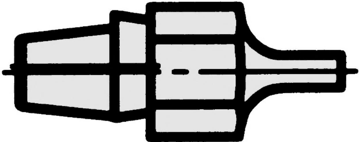
Exzenterbefestigung für schnellen Düsenwechsel
