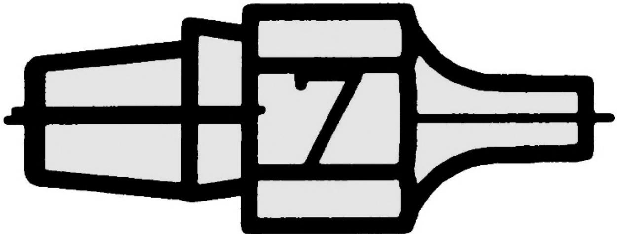
Exzenterbefestigung für schnellen Düsenwechsel
