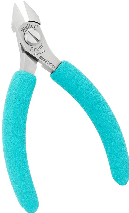
Der perfekte Schnitt - kraftvoll, scharf und langlebig. Immer. Die Weller Erem Serie 800 Maxi ist ein Sortiment großer Präzisionsschneider für allgemeine Schneidanwendungen in der Elektronik zum Schneiden großer Drahtdurchmesser. Die Schneider werden aus hochwertigem Werkzeugstahl mit auf 63-65 HRC gehärteten Schneidkanten hergestellt. Die Präzisionsschneider haben eine nicht reflektierende Oberfläche, sind ESD-sicher und können nachgeschärft werden.
