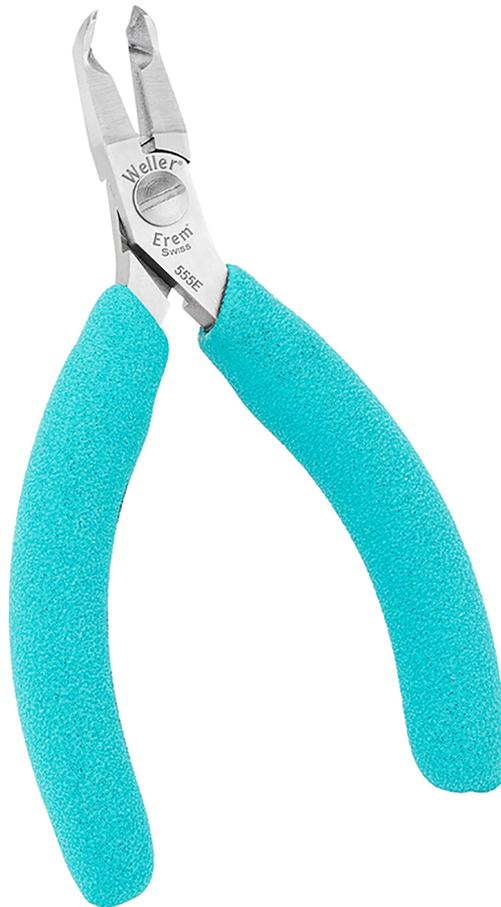
Der perfekte Schnitt - kraftvoll, scharf und langlebig. Immer. Die Weller Erem Serie 500 Micro ist ein vollständiges Sortiment mittelgroßer, robuster Präzisionsschneider mit einer großen Auswahl an Kopfformen. Die Schneider werden aus hochwertigem Werkzeugstahl hergestellt. Die Schneidkanten sind gehärtet auf Rockwell 63-65 HRc. Die Präzisionsschneider haben eine nicht reflektierende Oberfläche, sind ESD-sicher und können nachgeschärft werden.
