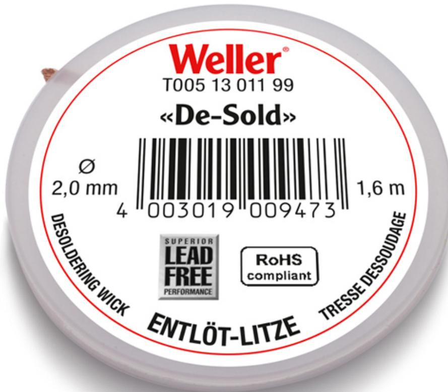
Entlötlitzen bestehen aus flussmittelgetränktem Kupfergeflecht. Durch das Flussmittel kann das Kupfer problemlos benetzt werden. Die Kapillarkraft in dem feinen Geflecht saugt das flüssige Lötzinn auf.
