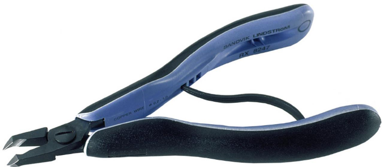
Aus Hochleistungs-Kugellagerstahl gefertigt, brüniert. Schneiden und Backen computergeschliffen, dadurch höchste Präzision und konstante Qualität. Induktionshärtung der Schneiden auf 63-65 HRC. Griffe aus 2 Komponenten, mit Öffnungsfeder.
