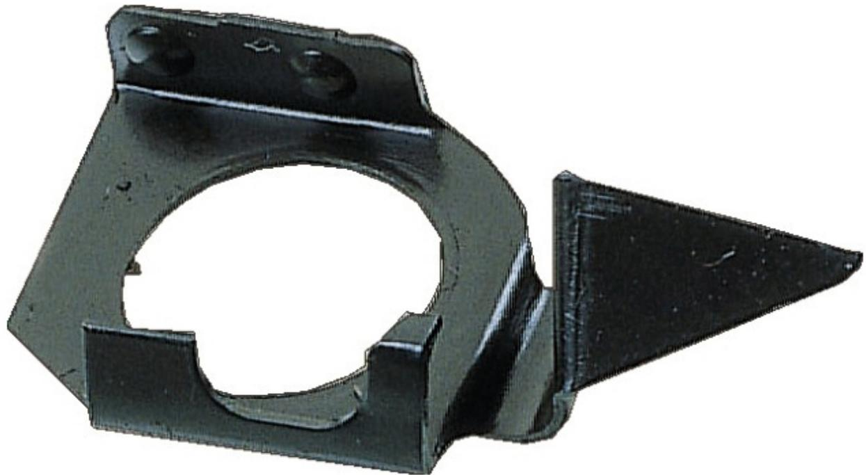
Mit dieser patentierten Klemmfeder lassen sich abgeschnittene Drahtstücke festhalten. Dadurch werden Schäden vermieden und abgeschnittene Drahtstücke fallen nicht in die Apparatur.
