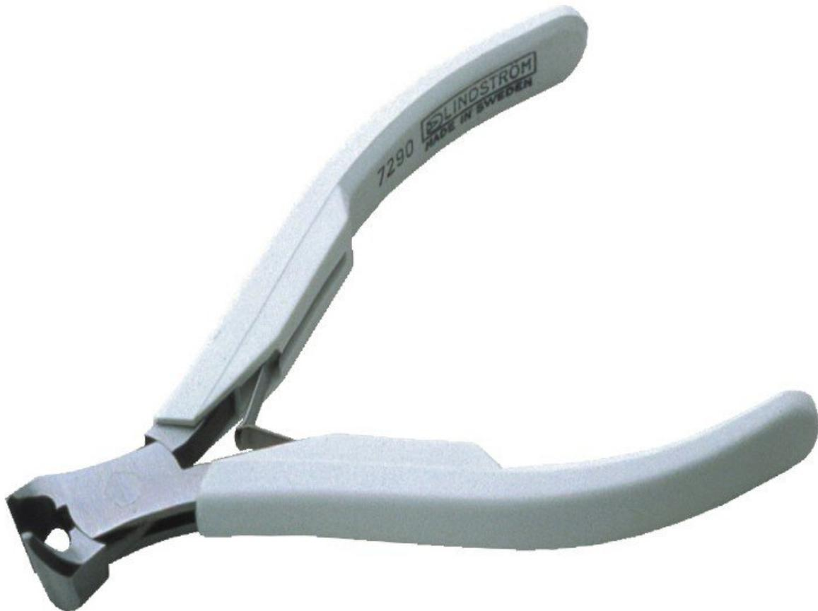
Aus Hochleistungs-Werkzeugstahl gefertigt. Spezialgeschmiedetes, durchgestecktes Gelenk mit extrem langen Führungen, ermöglicht durch spezielle Fertigungstechniken. Präzisionsinduktionshärtung der Schneiden auf 58-60 HRC. Mit Kunststoff-Griffhüllen und Öffnungsfeder.
