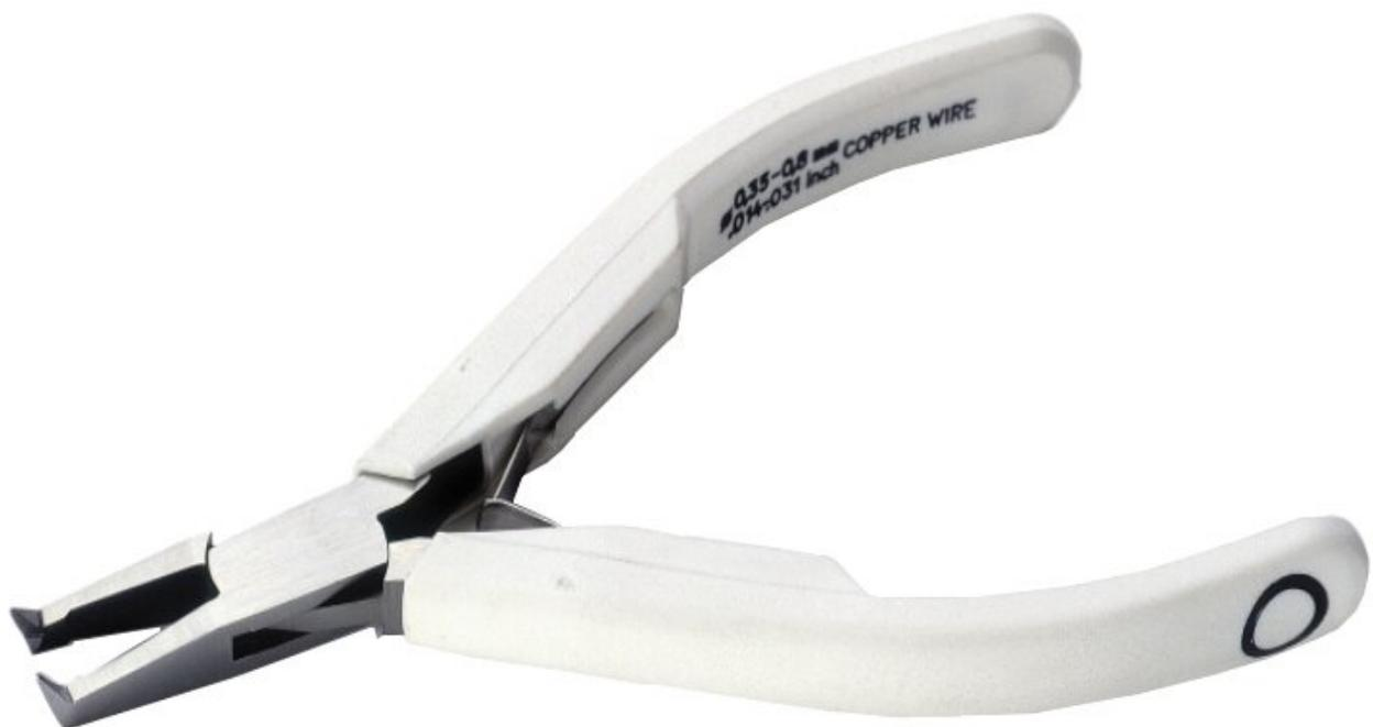
Aus Hochleistungs-Werkzeugstahl gefertigt. Spezialgeschmiedetes, durchgestecktes Gelenk mit extrem langen Führungen, ermöglicht durch spezielle Fertigungstechniken. Präzisionsinduktionshärtung der Schneiden auf 58-60 HRC. Mit Kunststoff-Griffhüllen und Öffnungsfeder.
