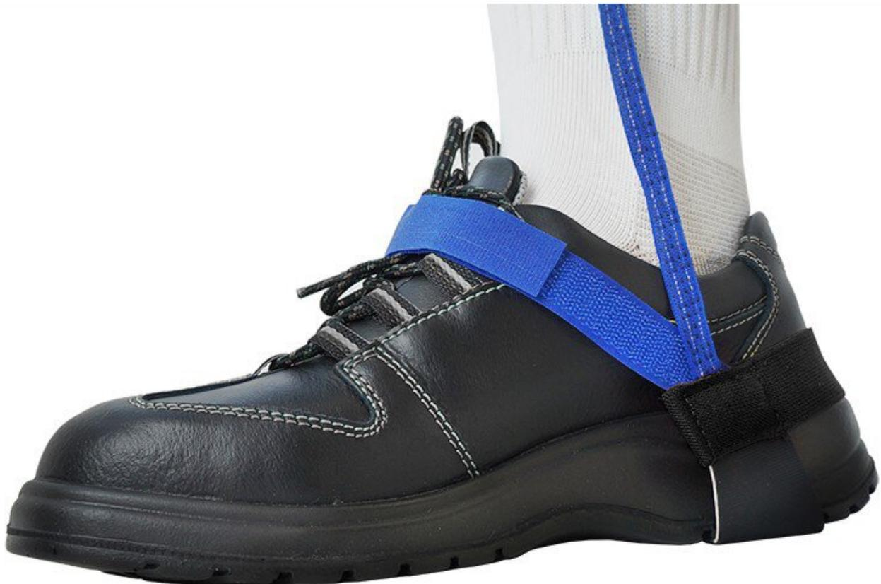
Das ESD-Fersenband von Safeguard ist ein wichtiges Zubehör für die korrekte Personenerdung. Es hat einen Ableitwiderstand von 1 MOhm und einen Klettverschluss. Das Fersenband dient dazu, statische Elektrizität von den Füßen abzuleiten und so Schäden an elektronischen Geräten und Bauteilen zu vermeiden. Der 1 MOhm Ableitwiderstand sorgt dafür, dass die Ableitung der statischen Elektrizität effektiv und sicher erfolgt. Das Band ist blau/schwarz und für Straßenschuhe mit flachen Absatz geeignet.
