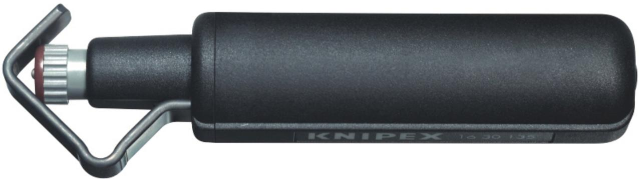
Zum Entfernen von Rundkabelmänteln aus PVC, Gummi, Silikon, PTFE. Selbstspannender Festhaltebügel. Mit Schnitttiefeinstellung per Rändelmutter. Drehbarer Griffkörper für Umfangs- und Längsschnitt. Wendelschnitt für das Entfernen von Zwischenstücken. Auswechselbare Klinge. - Abisolierwerte (Durchmesser): Ø 6,0 – 29,0mm
