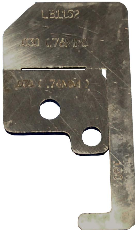
Spezial-Flachmesser für Flachband und mehradrige Leiter für 16 AWG Multileiter
