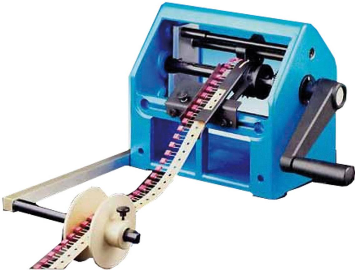
Schneidegerät für radiale Bauteile
