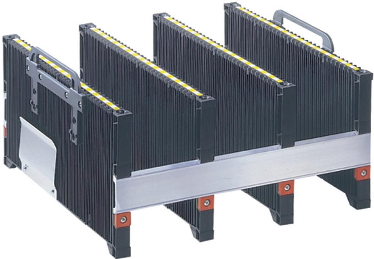
Die Leiterplattenhalter können sowohl in senkrechter als auch waagrechter Lage bestückt werden. Das System ist absolut variabel in der Breite und kann für alle Leiterplatten-größen bedarfsgerecht montiert werden. Für die verschiedenen Leiterplatten werden 100, 180 und 300 mm hohe Leiterplattenhalter angeboten. Mit 32 Führungsnuten im Abstand von 10 mm bieten die Leiterplattenhalter eine maximale Packungsdichte.
