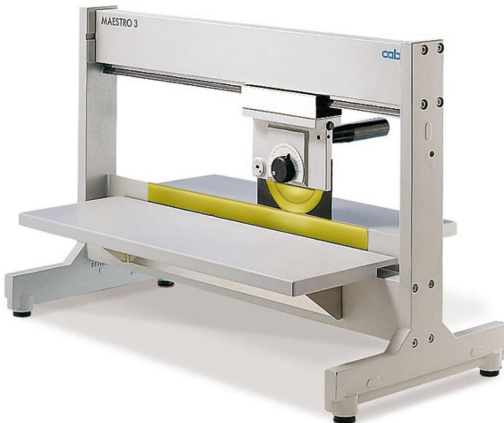
Mit dem MAESTRO 3E werden sowohl kleine als auch große Leiterplatten getrennt. Der Auflagetisch und die Ablage sind stufenlos auf die beste Arbeitsposition einstellbar. Der Abstand zwischen Linearmesser und Ablage kann so verändert werden, dass die Randstreifen durchfallen und aussortiert werden.
