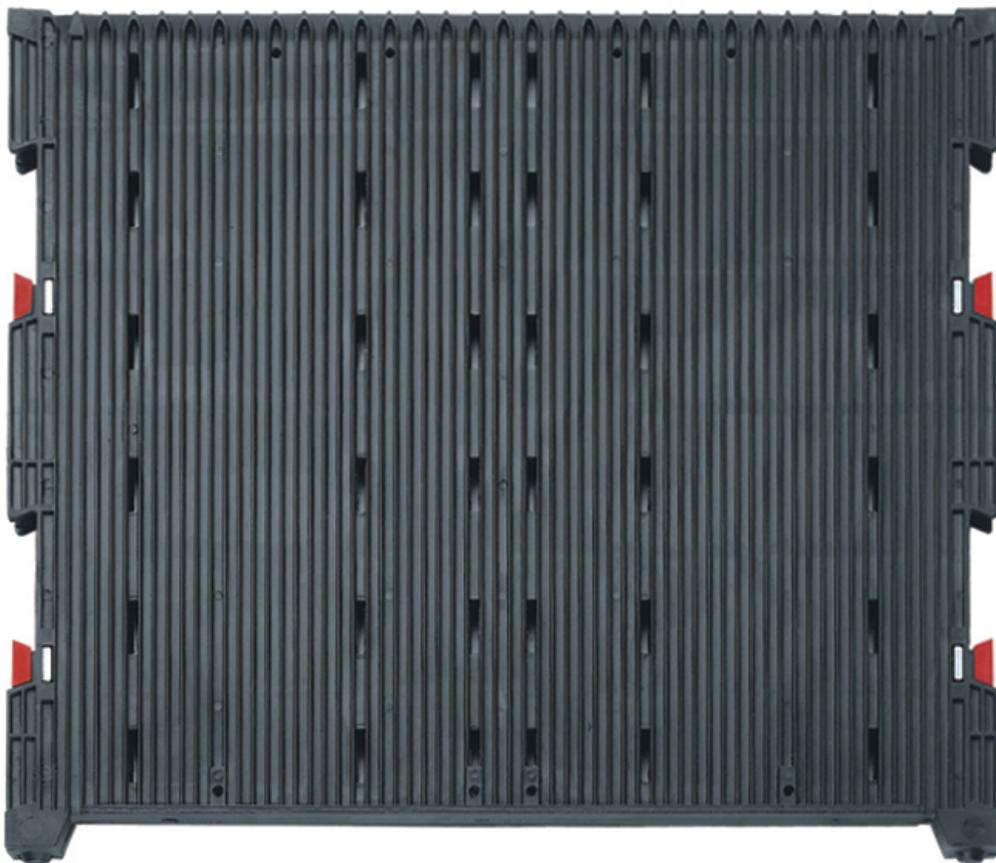
Die Leiterplattenhalter können sowohl in senkrechter als auch waagrechter Lage bestückt werden. Das System ist absolut variabel in der Breite und kann für alle Leiterplattengrößen bedarfsgerecht montiert werden. Für die verschiedenen Leiterplatten werden 100, 180 und 300 mm hohe Leiterplattenhalter angeboten. Mit 32 Führungsnuten im Abstand von 10 mm bieten die Leiterplattenhalter eine maximale Packungsdichte.
