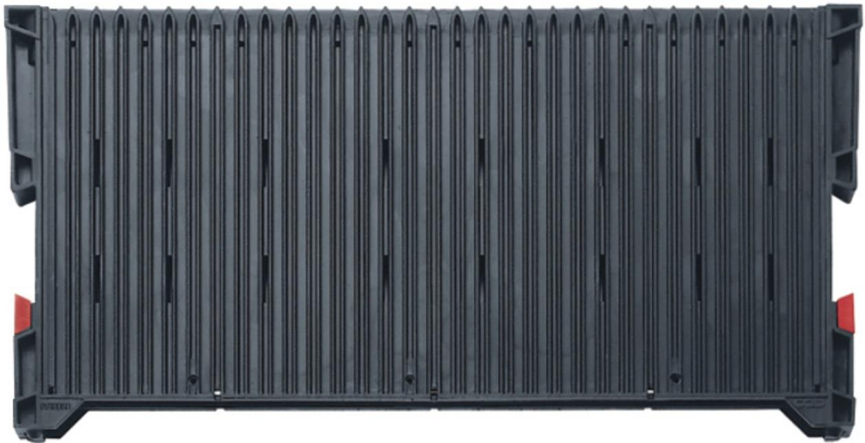
Die Leiterplattenhalter können sowohl in senkrechter als auch waagrechter Lage bestückt werden. Das System ist absolut variabel in der Breite und kann für alle Leiterplatten-größen bedarfsgerecht montiert werden. Für die verschiedenen Leiterplatten werden 100, 180 und 300 mm hohe Leiterplattenhalter angeboten. Mit 32 Führungsritzen im Abstand von 10 mm bieten die Leiterplattenhalter eine maximale Packungsdichte.
