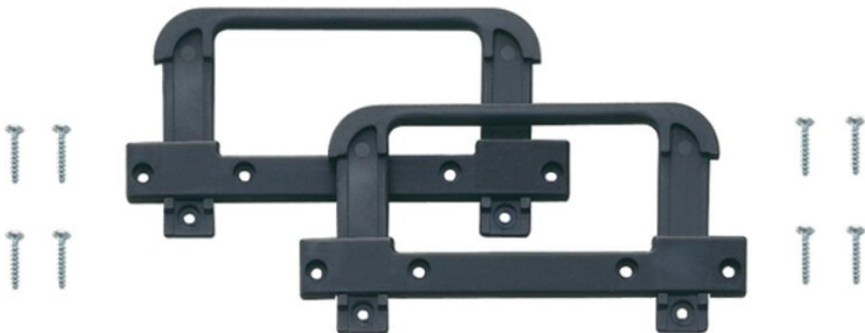
Die Leiterplattenhalter können sowohl in senkrechter als auch waagrechter Lage bestückt werden. Das System ist absolut variabel in der Breite und kann für alle Leiterplattengrößen bedarfsgerecht montiert werden. Für die verschiedenen Leiterplatten werden 100, 180 und 300 mm hohe Leiterplattenhalter angeboten. Mit 32 Führungsnoten im Abstand von 10 mm bieten die Leiterplattenhalter eine maximale Packungsdichte.
