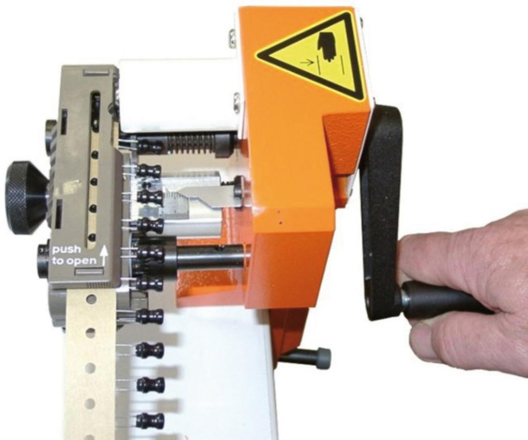
Schneidegerät für radiale Bauteile
